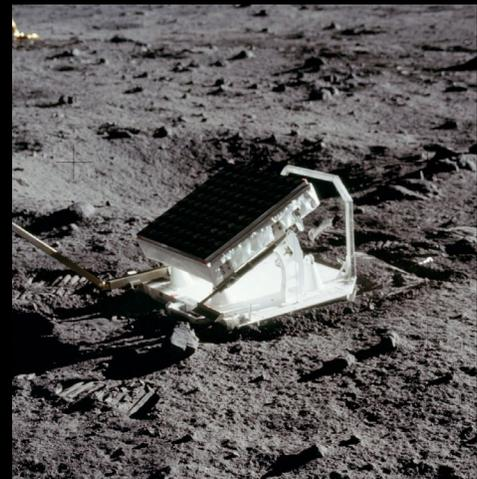
Los astronautas del Apolo 11 colocaron este conjunto de espejos en la Luna. Al hacer reflejar los láseres en estos espejos, los científicos en la Tierra pueden medir la distancia hasta la Luna en forma muy precisa.
