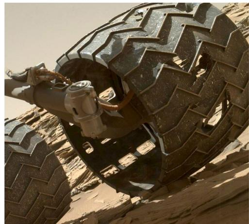
*Curiosity* tomó esta foto de sus propias ruedas en el año 2016 para buscar señales del daño causado por unas rocas afiladas. A pesar de que parecen llantas de caucho, las ruedas del *Curiosity* están, en efecto, hechas de piezas sólidas de aluminio.
