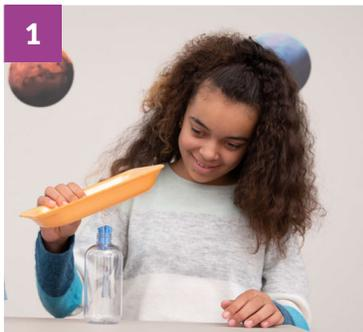
Experimenta con el *electroscopio* modelo, un instrumento que se utiliza para detectar las cargas eléctricas. Primero, frota la bandeja de espuma sobre el fieltro de lana durante unos diez segundos para cargarla. Después, mueve la bandeja hacia arriba y hacia abajo cerca del alambre en la parte de arriba del electroscopio, sin que la bandeja toque el alambre. ¿Qué sucede adentro con las formas de papel aluminio?
