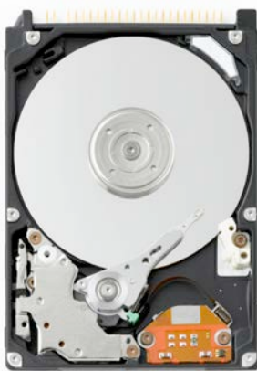
Interior de un disco duro
