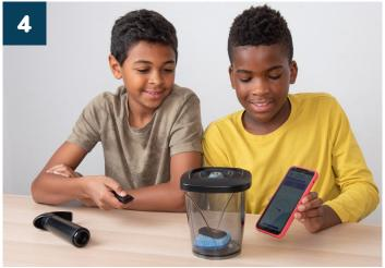
Ahora, trata de medir el volumen del localizador de llaves en la cámara de vacío —con la tapa puesta—antes y después de sacarle el aire. **Después de extraer el aire, ¿qué sucede cuando activas el localizador de llaves?** Intenta otras fuentes de sonido en la cámara de vacío. ¿Qué pasa?
